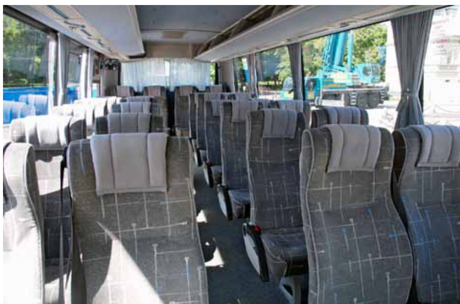
Cestující mají k dispozici polohovací sedadla, která jsou podélně posuvná
